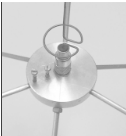
Obr. 7 – Detailní pohled na základnu antény.
